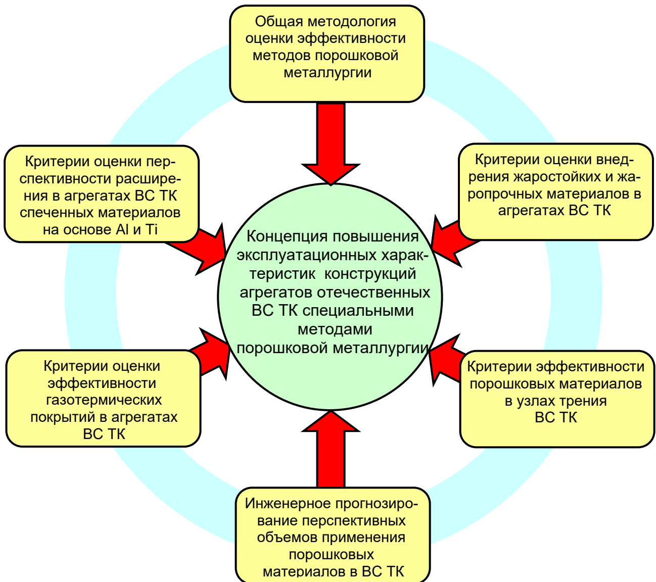
Рисунок 2 – Основные составляющие концепции повышения эксплуатационных характеристик конструкций агрегатов отечественных гражданских самолетов методами порошковой металлургии
