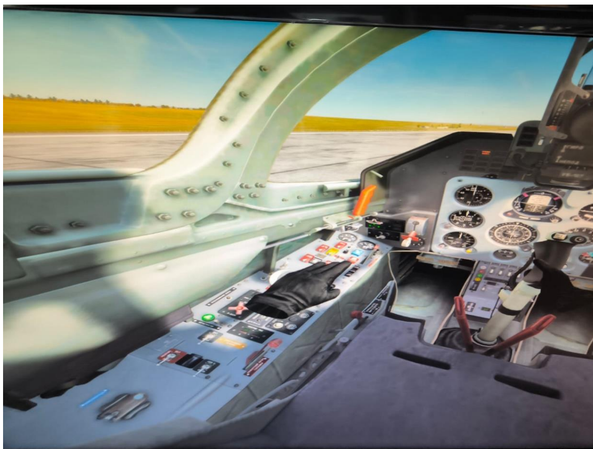
Рис.1. Відображення у віртуальній реальності кабінного простору літака L-39
