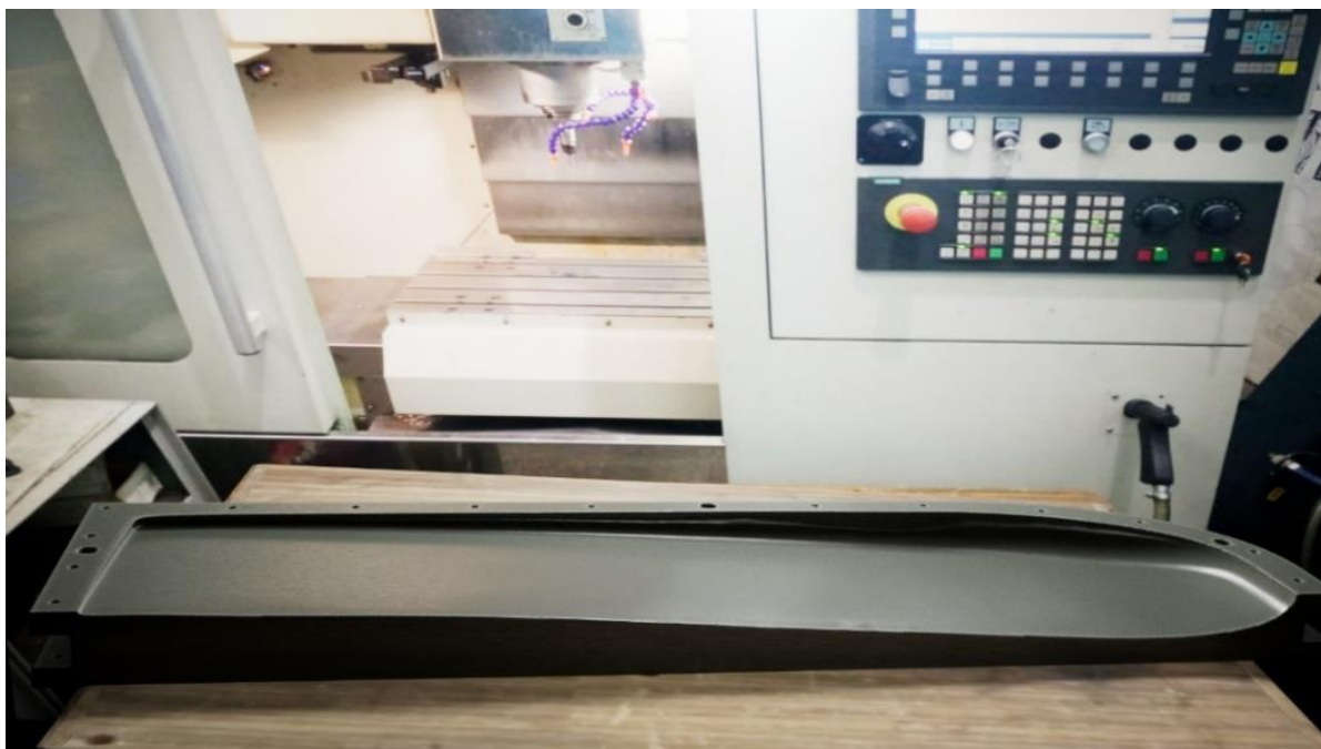
Рис. 8. Нижня частина матриці кінцевого обтікача крила
