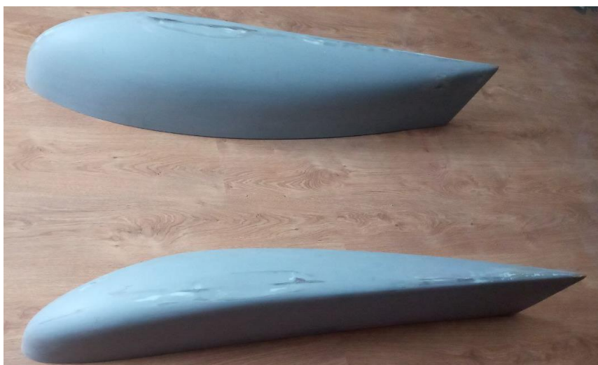
Рис. 1. Комплект кінцевих обтікачів крила ЛА «Бекас» Х-22
