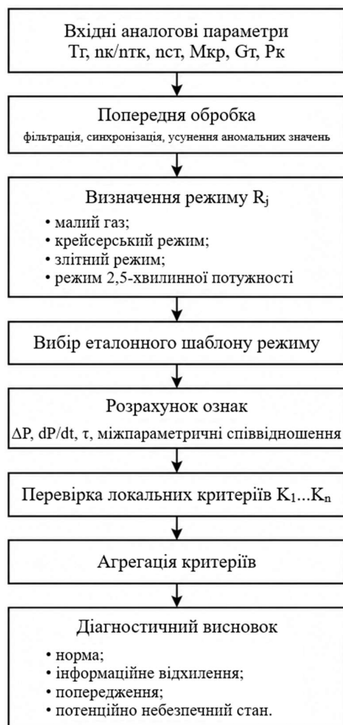
Рис. 1. Узагальнена схема режимно-залежного післяпольотного параметричного контролю ГТД ТВ3-117В
