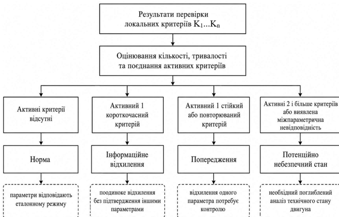
Рис. 3. Логіка формування діагностичного висновку на основі режимно-залежних критеріїв
