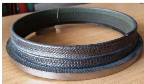
Рис. 2. Фотографія зовнішнього кільця, що входить до складу турбіни двигуна AI-222, виготовленого методом мікроплазмового порошкового наплавлення [19]
