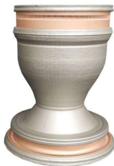
Рис. 5. Біметалічна камера згоряння: лайнер із GRCor-42, виготовлений методом L-PBF, і зовнішня оболонка зі сплаву NASA HR-1, сформована методом LP-DED (RPM Innovations / NASA) [2]
