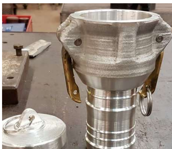
Рис. 3. Гідравлічне кулачкове швидкокорознімне з'єднання з алюмінієвого сплаву 6061, виготовлене методом холодного газодинамічного напилення (SPEE3D) [7]
