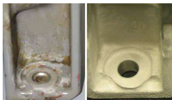
Рис. 4. Фотографії корпусів до (а) та після відновлення (б) [24]
