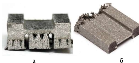
Рис. 1. Фотографії зразків, отриманих методом SLM (100 Вт, 300 мм/с), у різних орієнтаціях: (а) вертикальній та (б) поздовжній [9]
