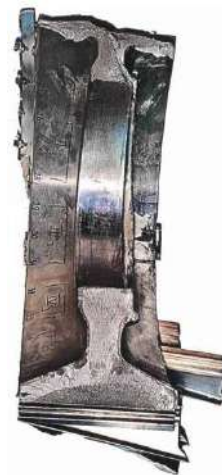
Рис. 2. Фрагмент диска вентилятора після руйнування
