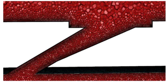
Рис. 3. Фрагмент поліедральної розрахункової сітки розміром 5,8 млн. елементів для отвору 7-7-7 у виконанні з реалістичною траншеєю глибиною 0,4D
