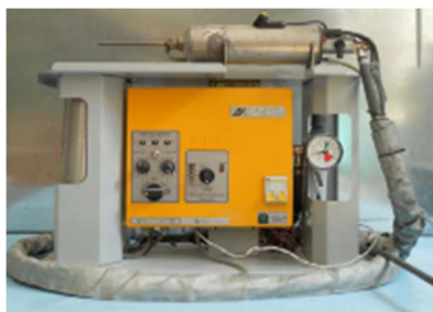
Рис. 2. Установка ХГН ДИМЕТ-405
