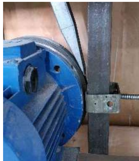
Рис. 4. Установка для проведення досліджень на абразивне зношування вільним абразивом
