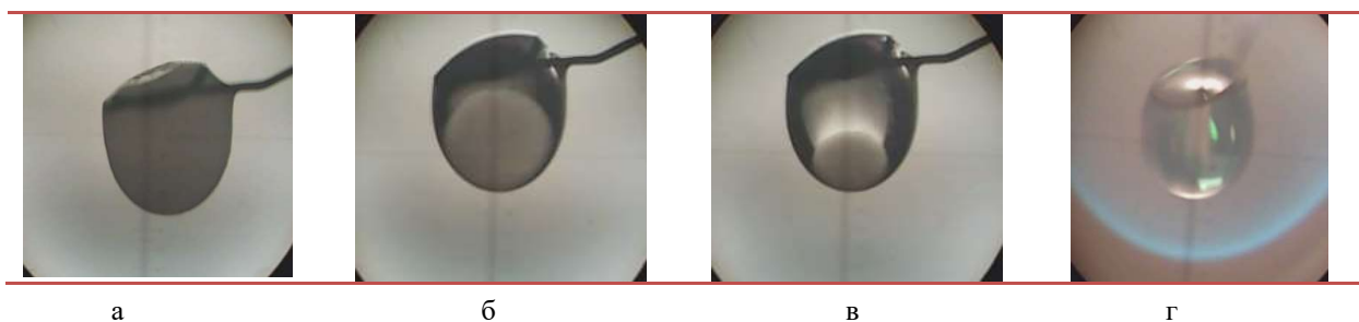
Рис.1.Цифрові зображення зразка парафіну на стадіях: а - нагрівання; б, в – плавлення; г - горіння (блакитний колір – нижня межа полум'я).
