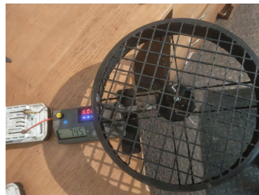
Рис. 4. Захисна сітка, створена на основі конфігурації 2 (комірка 20×20 мм) шляхом повного демонтажу її нижньої частини
