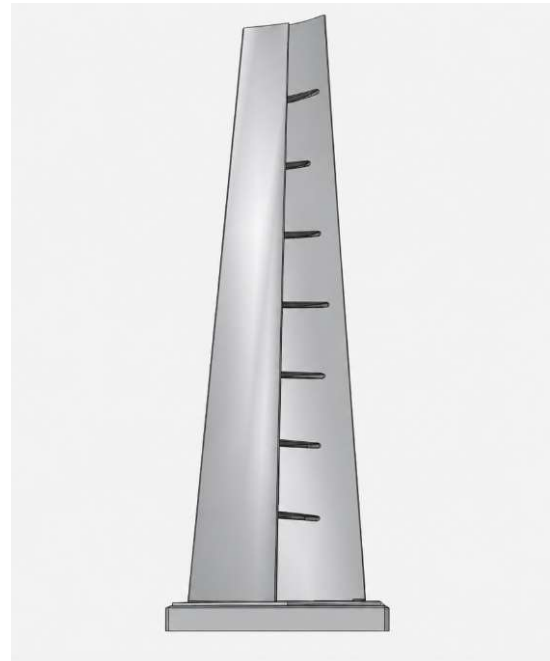
Рис. 1. Решітчаста дворядна лопатка вентилятора [2]
