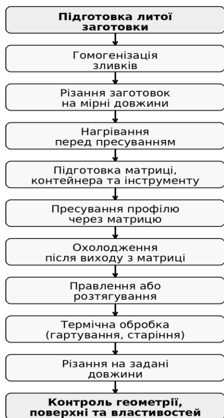
Рис. 1. Узагальнена схема технологічного процесу виготовлення профілю з алюмінієвого сплаву
