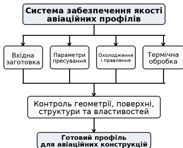
Рис. 5. Система технологічного забезпечення якості профілів авіаційного призначення
