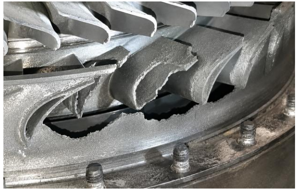
Рис. 6. Прогар зовнішнього корпусу соплового апарата та руйнування двох лопаток соплового апарата 1-го ступеня
