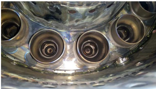
Рис. 7. Стан деталей камери згоряння після типових випробувань технологічного двигуна [10]
