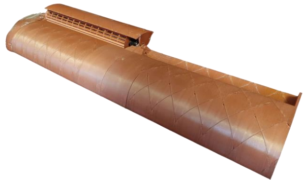
Рис. 13. Натурна модель крила, на якій права консоль представлена з пропульсивною установкою, а ліва в розібраному стані, для демонстрації форми
