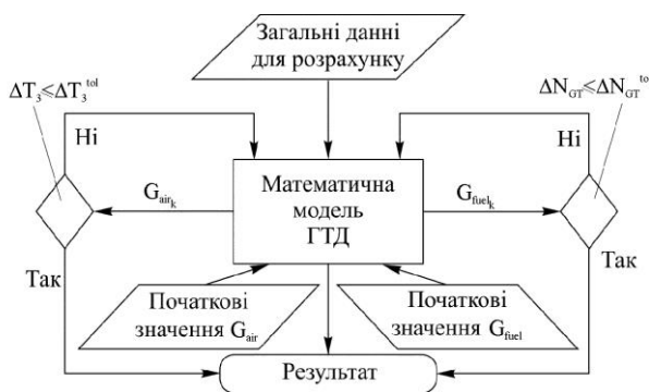
Рис. 1. Алгоритм налаштування моделі ГТД при її верифікації за цільовими функціями N_{GT} = f(G_{fuel}) та T_3 = f(G_{air})
