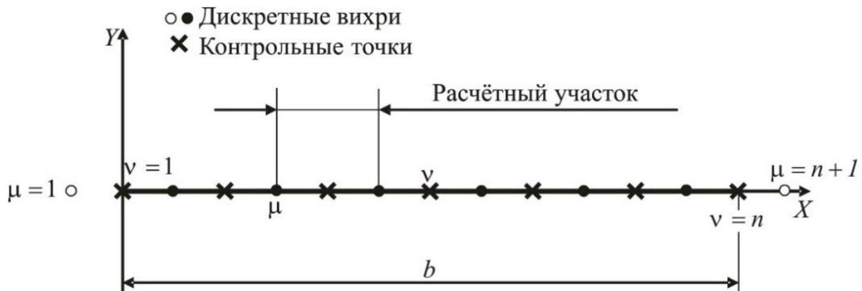
Рисунок 3 – К вихревой схеме нестационарной отрывной задачи
