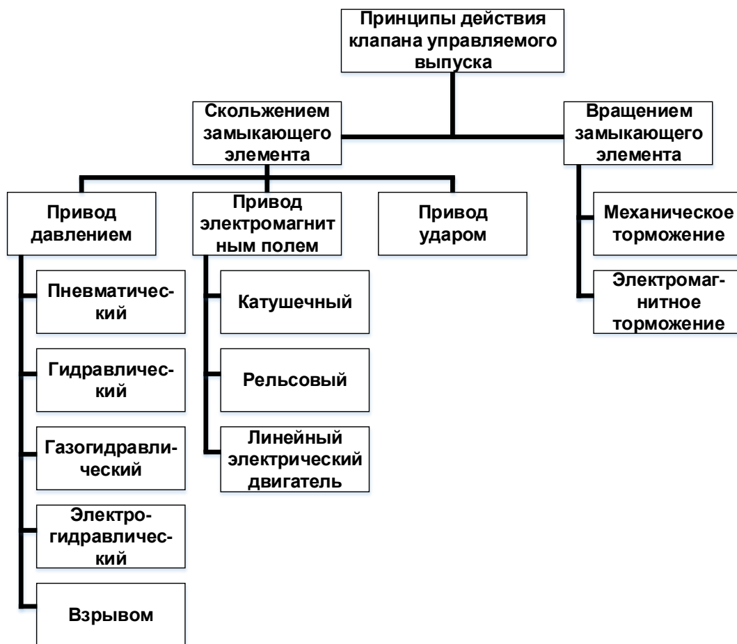
Рисунок 3 – Принципы действия клапана управляемого выпуска
