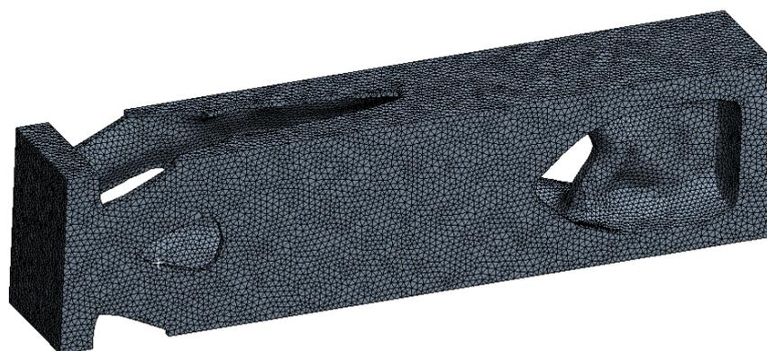
Рисунок 5 – Конечно-элементная модель оптимизированной балки
