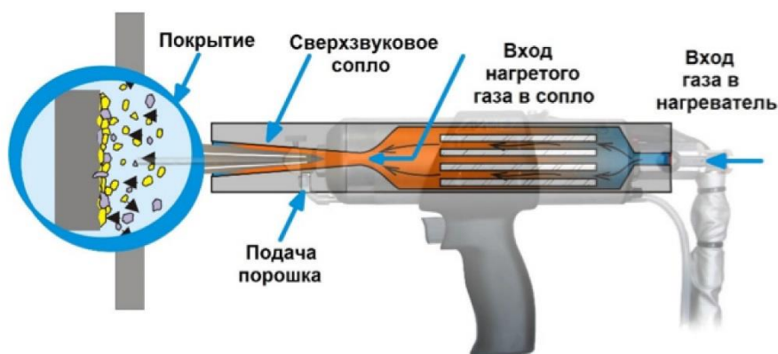
Рисунок 1 – Схема процесса газодинамического напыления на препрег
