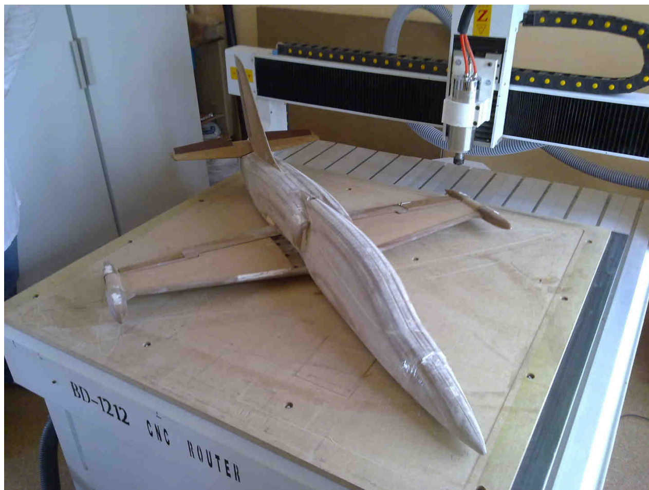
Рис. 7. Собранная продувочная модель самолета Л-39
