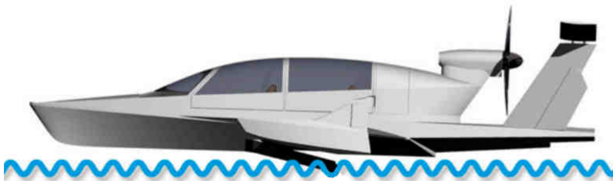
Рис. 7. Схема экраноплана-аналога ЭП-15 на взлетном режиме с отклоненной гидролыжей
