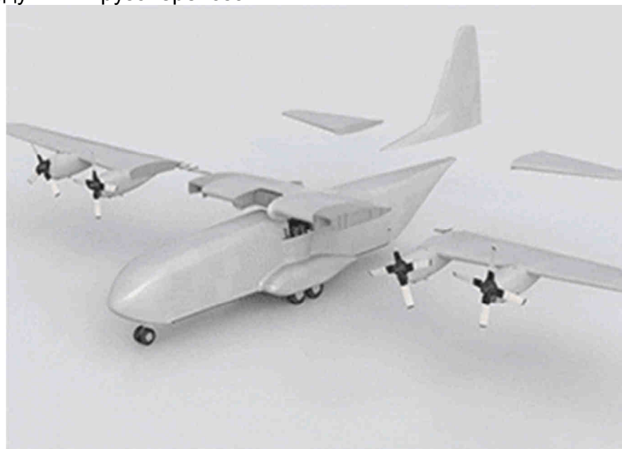
Рис. 2. Схема самолета C-130H Hercules с заменой фюзеляжа и системы управления
