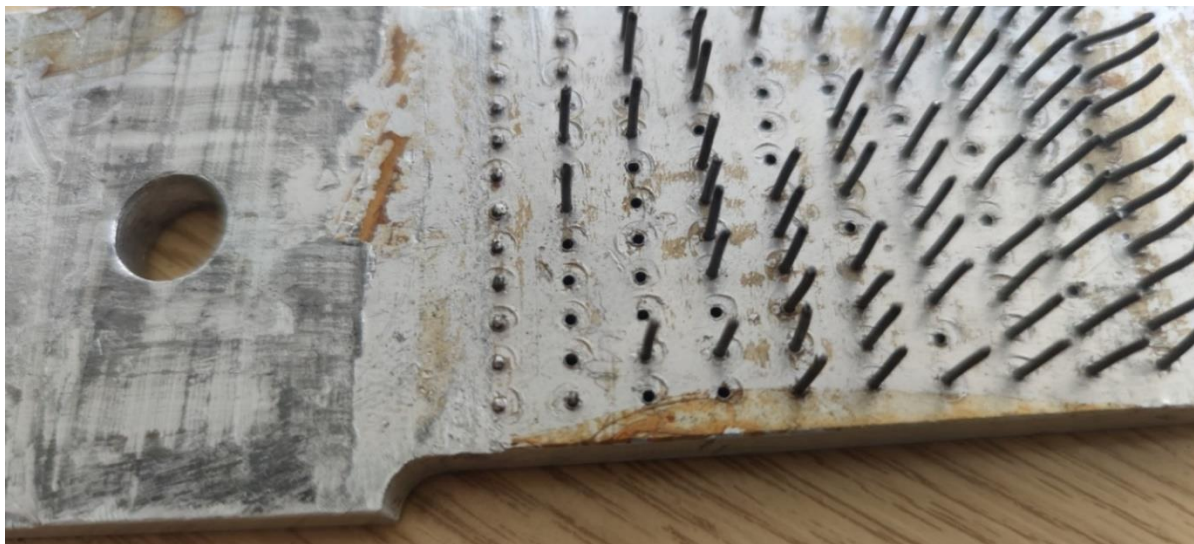
Рис. 10. Зовнішній вигляд металевої закінцівки зразка, зі знятим пакетом композита після руйнування.
