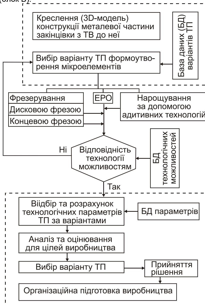
Рис. 4. Загальна структура ТПВ формоутворення мікроелементів на металевій закінцівці з'єднання. Пунктиром показано загальна частина структури ТПВ для усіх варіантів конструкцій мікроелементів; ТВ – ,технологія виробництва, ТП – технолгічний процес, ЕРО – електро-ерозійна обробка
