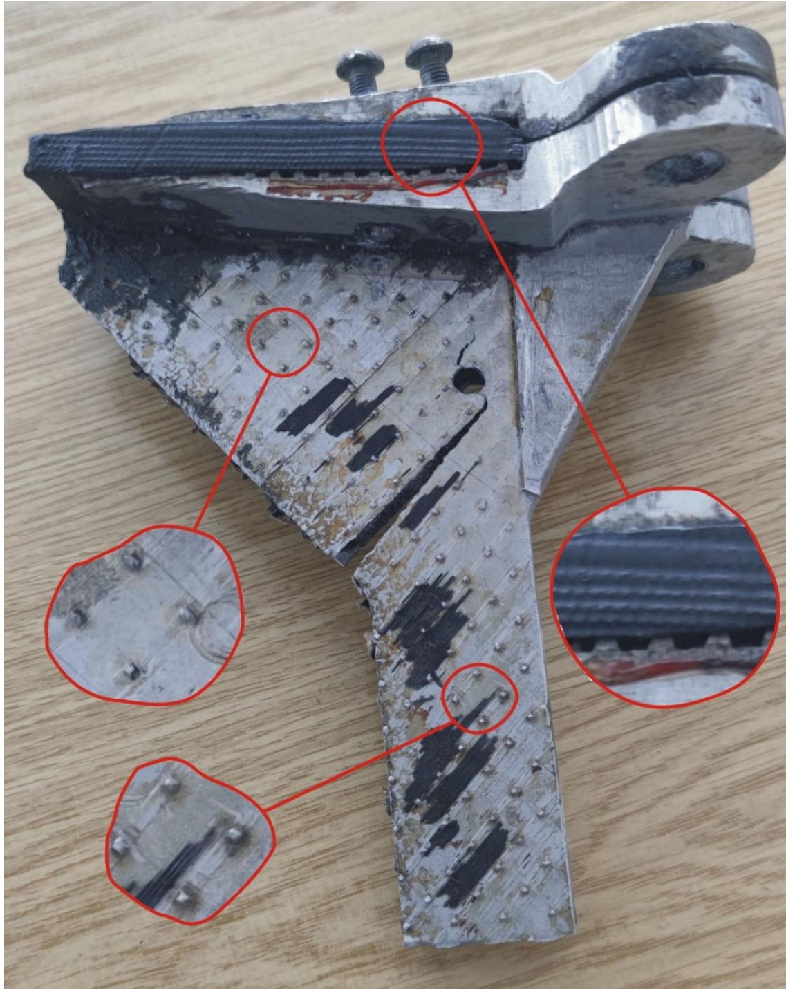
Рис. 11. Фрагмент конструкції фітингу лонжерону після випробувань. Матеріал закінцівок – Д16Т, композитної частини закінцівки – вуглепластик 02С300UAP/Araldite LY556, структура [0_{10}/90_4/+45_8/-45_8]
