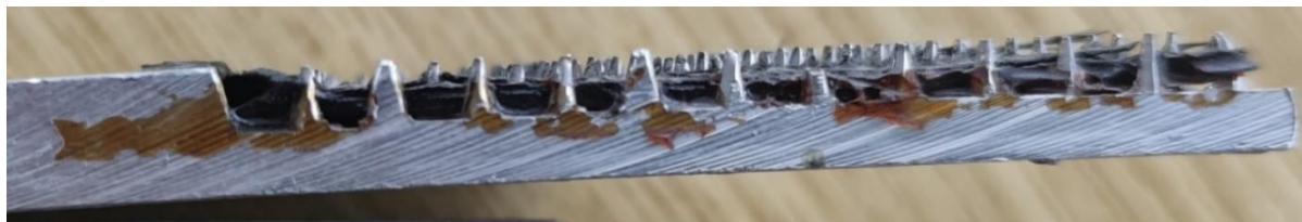
Рис. 9. Повздовжній переріз зруйнованого шляхом розшарування зразка. Зразок препарований вздовж у площині ряду пірамідальних КЕ у нахлестковому з'єднанні
