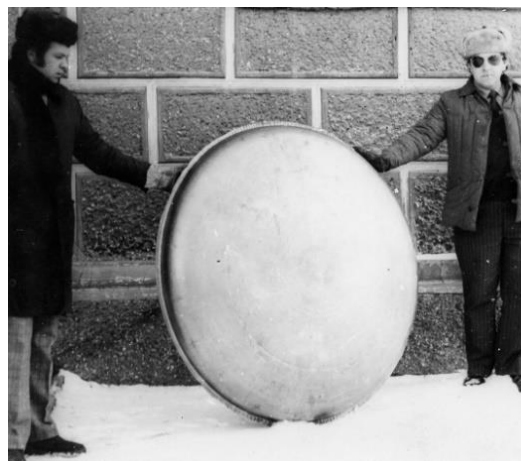
Рис. 4 – Напівеліптичне днище \varnothing 1350 мм, глибина 170 мм, товщина 1,6...2,0 мм. Матеріал – сталь 30. Енергія: 50 розрядів \times 36 кДж; U_0 = 36 кВ
