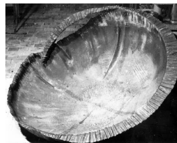
Рис. 2 – Приклад браку при нерівномірному витягуванні фланцю [9]
