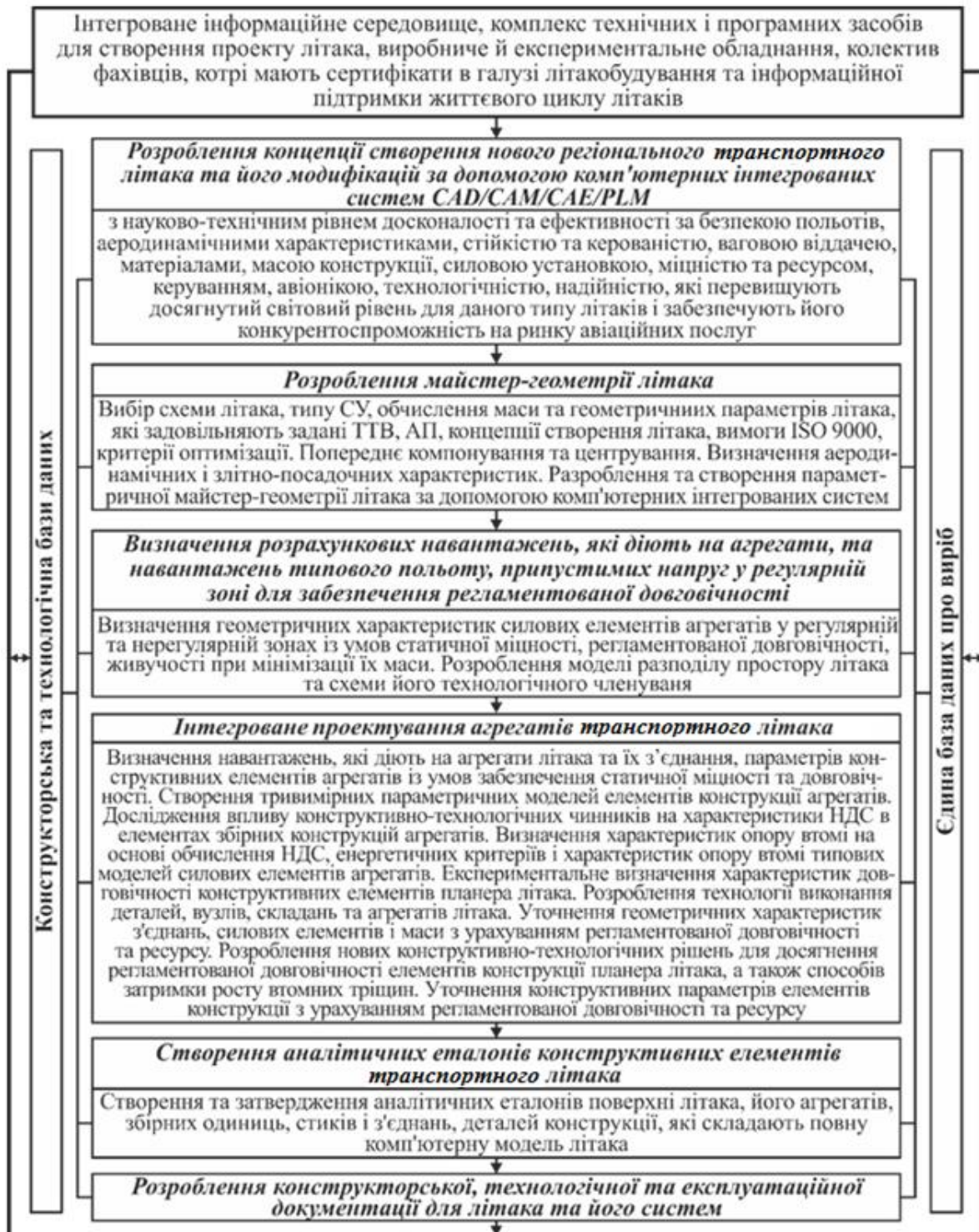
Рис. 1. Блок-схема загального методу інтегрованого проектування літака транспортної категорії
