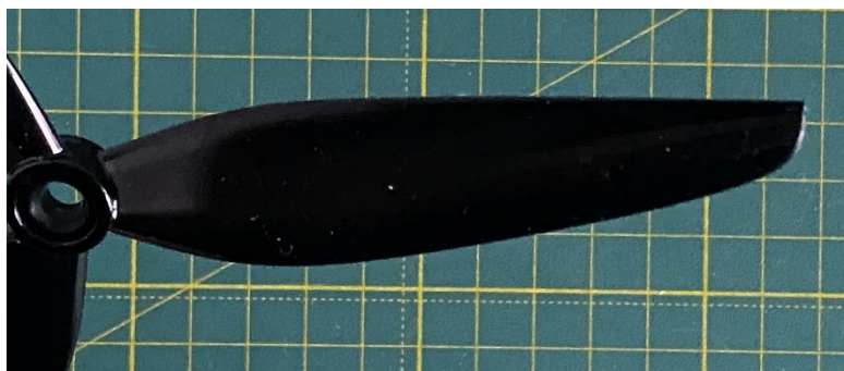
Рис. 12. Вид лопаті оригінального пропелера HQProp V1S 7x3,5x3 зверху
