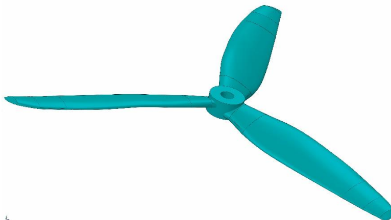
Рис. 18. Тривимірна модель пропелера 05 HQ V1S 7in_01
