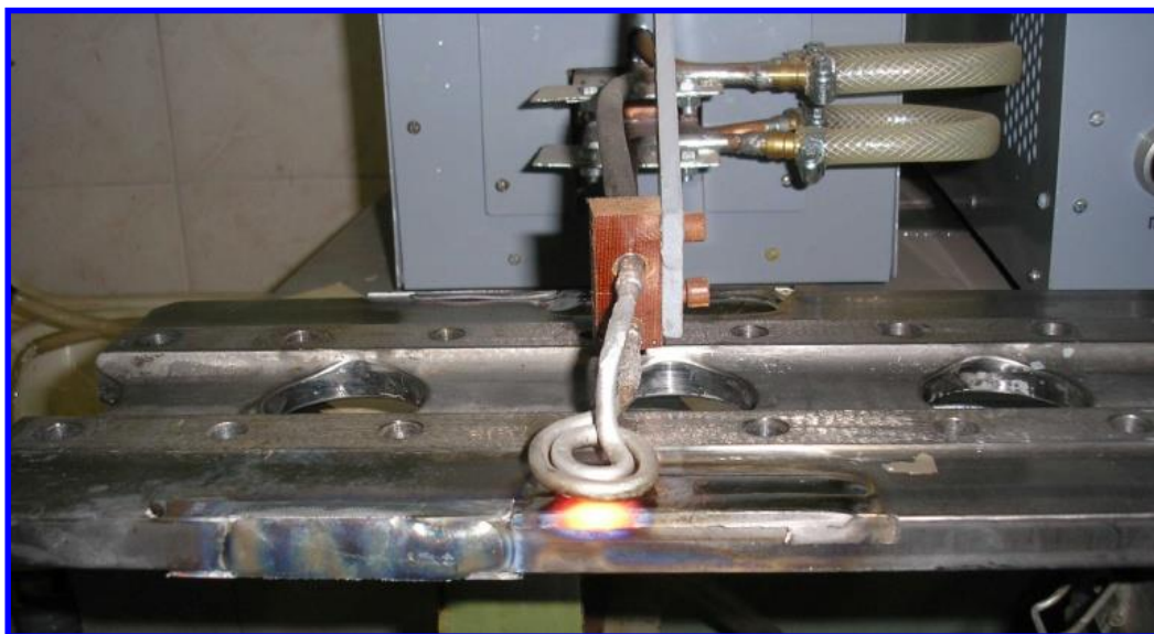
Рис. 3. Ремонт титанових напрямних наплавкою титана з наступним шліфуванням
