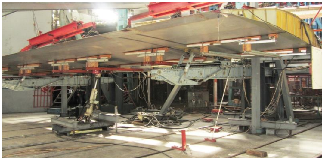
Рис. 2. Випробування закрилка і механізмів його навішування літака Ан-124.
