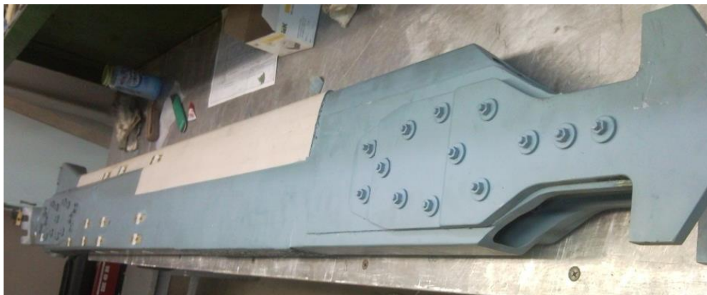
Рис. 8.1. Образец лопасти несущего винта вертолета
