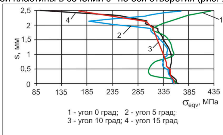
Рис. 17. Распределение эквивалентных напряжений по Мизесу по толщине верхней пластины в сечении 0^\circ
