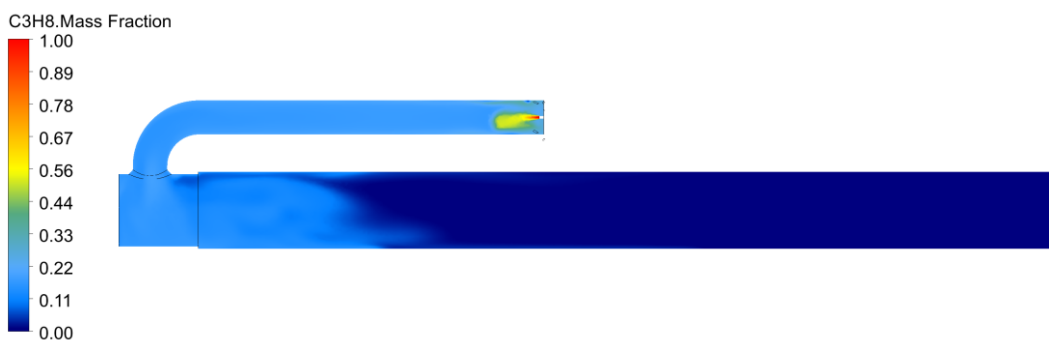
Рис. 8. Масова концентрація палива у центральному перерізі змішувача.
