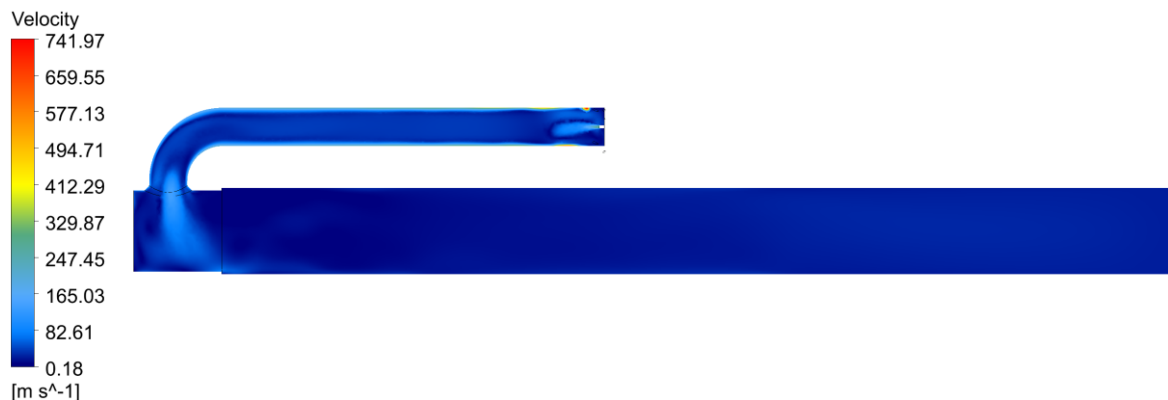
Рис. 4. Поля швидкостей у центральному перерізі змішувача у каналах розміновувача
