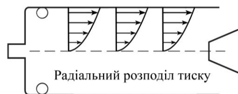
Рис 2. Схематичне зображення радіального розподілу статичного тиску у вихровій трубі
