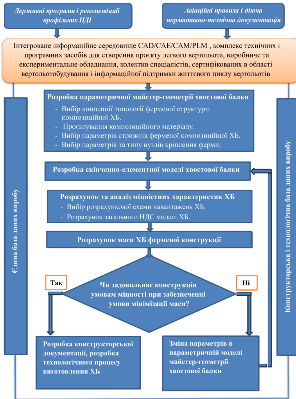
Рис. 2. Блок-схема методу інтегрованого проєктування ферменої хвостової балки легкого вертольоту
