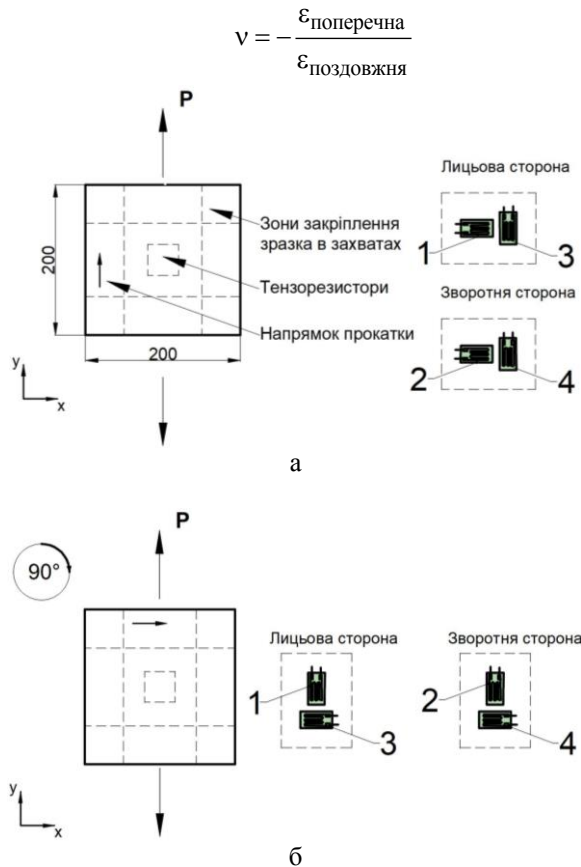
Рис. 2. Зразок для проведення випробувань з визначення коефіцієнта Пуассона: а – перший етап (уздовж прокатки); б – другий етап (поперек прокатки)
