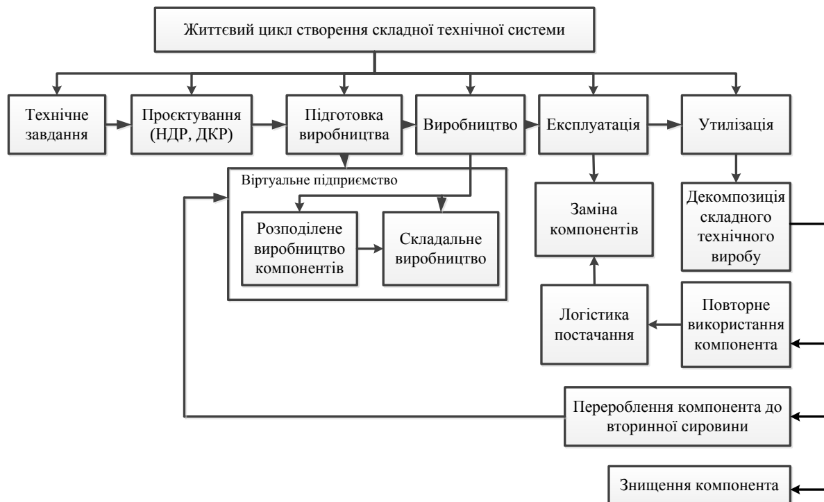
Рис. 1. Модель взаємодії логістичних процесів утилізації високотехнологічного виробу
