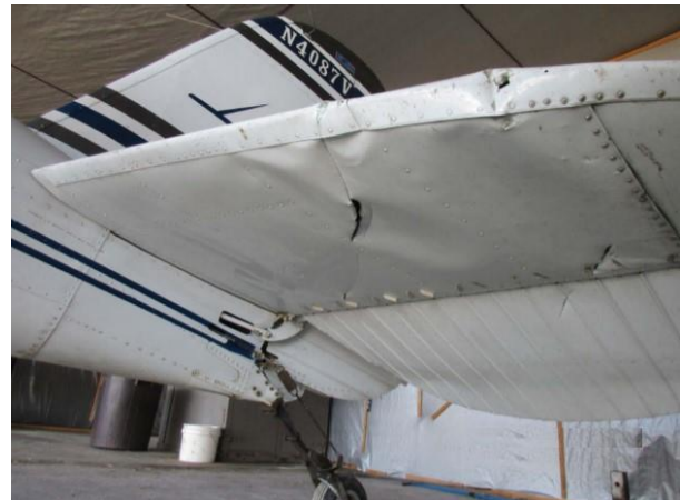
Рис. 4. Часткове пошкодження обшивки передньої кромки стабілізатора [3]
