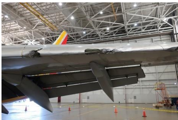
Рис. 3. Пошкодження передньої кромки лівого крила [2]
