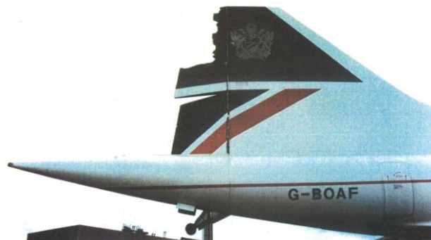
Рис. 5. Concorde, який отримав пошкодження керма напрямку [4]
