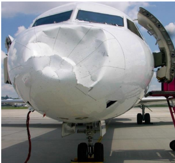
Рис. 2. Значні пошкодження носового обтічника літака [1]
