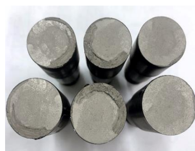
Рис. 3. Зразки з покриттями після дослідження адгезійної міцності
