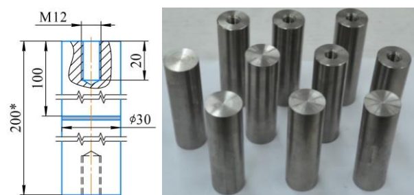
Рис. 4. Циліндричний зразок стикового з'єднання для визначення границі міцності при відриві
