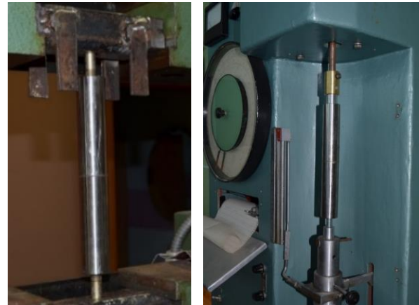
Рис. 9. Випробування зразків для визначення границі міцності клеїв при відриві
