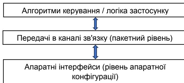
Рис. 2. Діаграма циркуляції цифрової інформації в ПЛК
