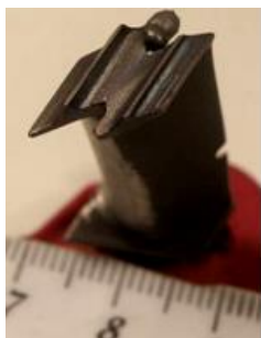
Рис. 3. Лопатки після відновлення Z-подібного профілю (основний та напалвлений метал – сплав ЖС6К)
