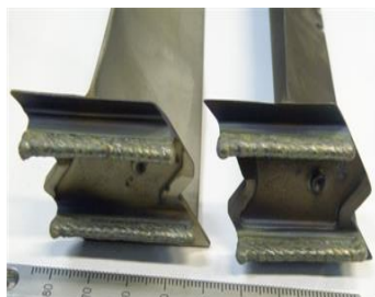
Рис. 4. Лопатки після відновлення лабіринтних гребінців (основний метал – сплав ЖС6К, матеріал напалвлення – сплав Stellite 12)
