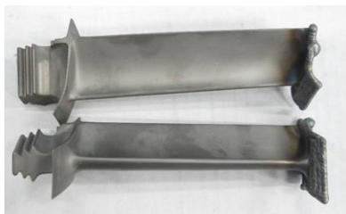
Рис. 1. Лопатки після відновлення бандажної полиці (основний метал – сплав ЖС26-ВИ, матеріал напалвлення – сплав ЖС32ВИ)
