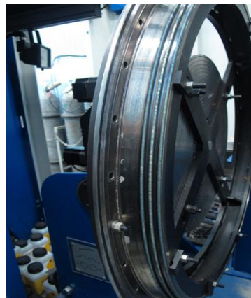
Рис. 5. Диск після відновлення лабіринтних гребінців (основний метал – сплав ЭП742-ИД, матеріал напалвлення – 1-3 шар сплав - NISTELLE C, 4-й шар – ВЗК)
