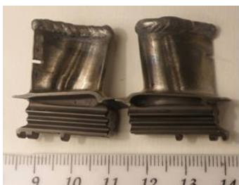
Рис. 2. Лопатки після відновлення торця пера (основний та напалвлений метал – сплав ЖС32-ВИ)
