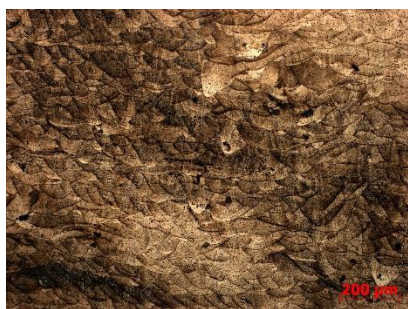
Рис. 2. Мікроструктура основного тіла дослідних зразків
