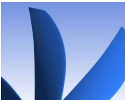
Рис. 3. Схема здійснення видування додаткової маси повітря на лопаті
