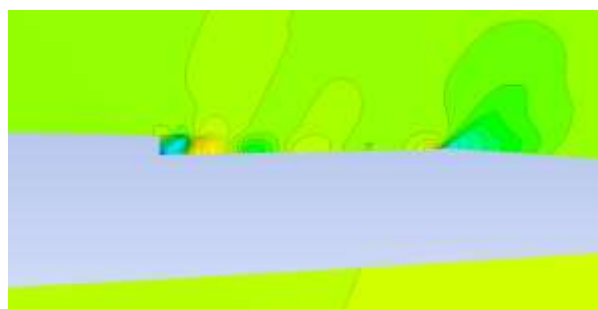
Рис. 5. Фрагмент поля тиску лопаті з управлінням примежовим шаром в області видування
