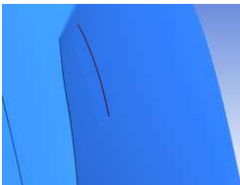
Рис. 2. Фрагмент твердотільної моделі лопаті співвісного гвинтовентилятора зі спеціальною щілиною для видування
