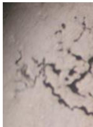
Рис. 2. Микропористость и пленки в образцах сплава МЛ5 с присадкой нанопорошка углерода 0,1 %, x200
