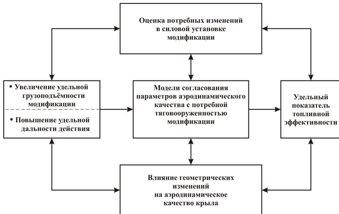
Рис. 1. Схема согласования изменений в геометрии крыла и в силовой установке на этапе предварительного проектирования модификаций
