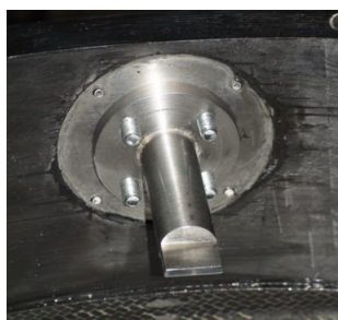
Рис. 2. Опора (имитатор сферических опор крепления главного зеркала)
