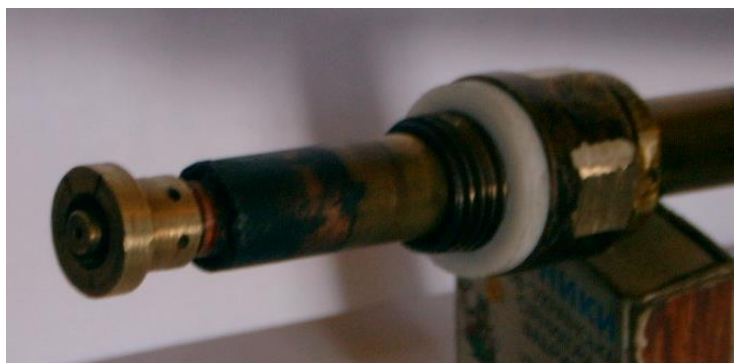
Рисунок 3 – Общий вид узла перемещения форсуночной головки со смесительным элементом
