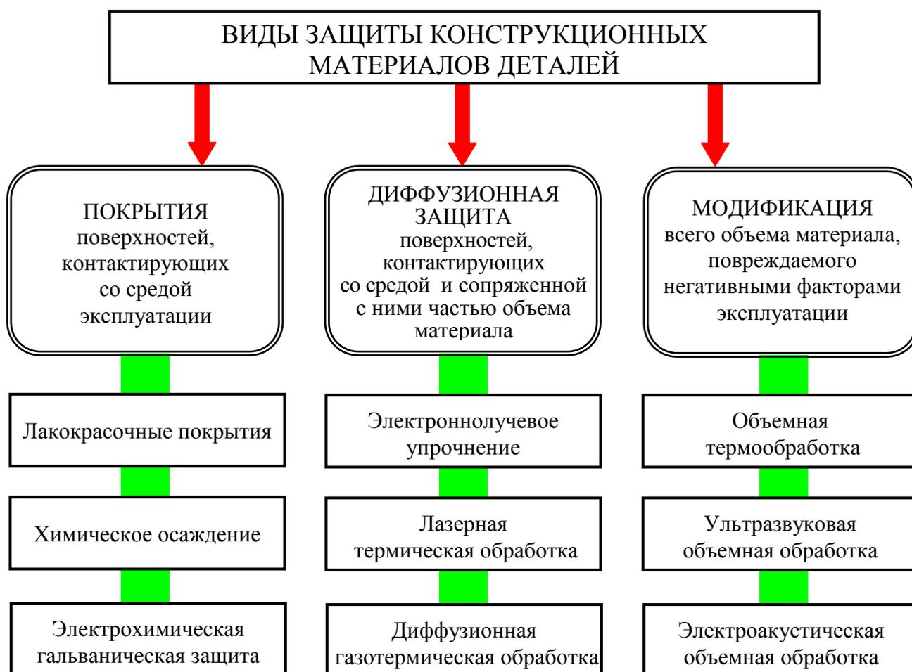
Рисунок 1 – Классификационная схема видов защищенности (эксплуатационной безопасности) деталей конструкционных материалов от негативных факторов среды эксплуатации
