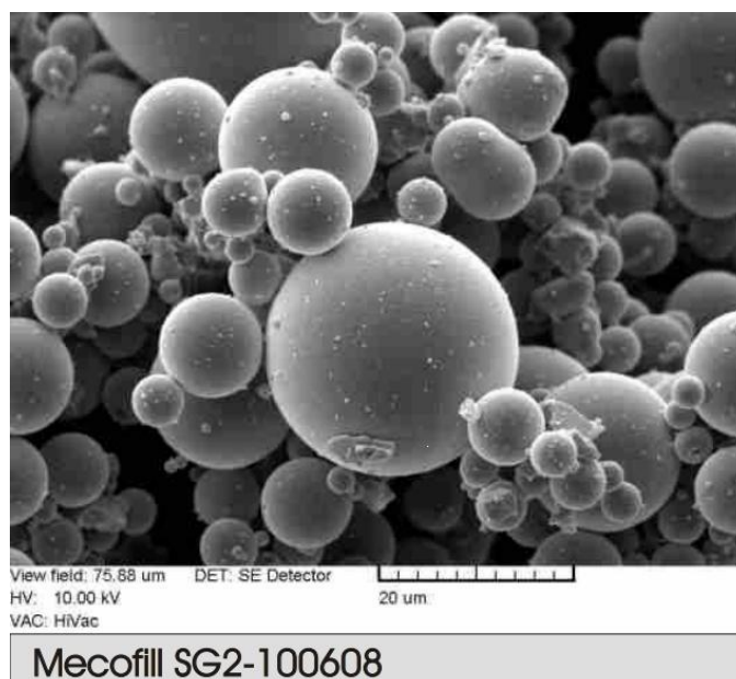
Рисунок 3 – Внешний вид товарных стеклянных микросфер торговой марки Mecofill SG2-100608 производства Brazel Technology GmbH (Германия) с серебряным покрытием
