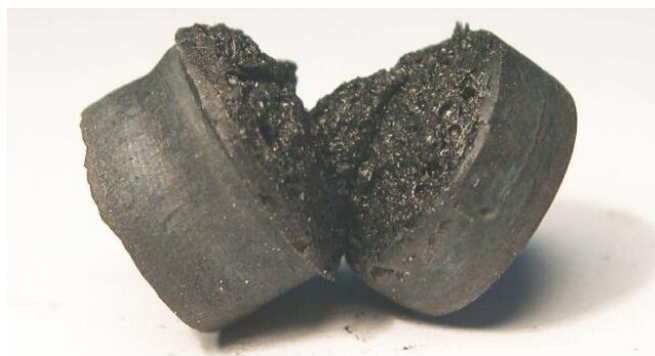
Рисунок 1 – Внешний вид образца резины 1001 после измерения удельной теплоемкости
