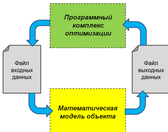
Рисунок 4 – Взаимодействие программных комплексов многокритериальной оптимизации и математической модели с использованием входных и выходных текстовых файлов
