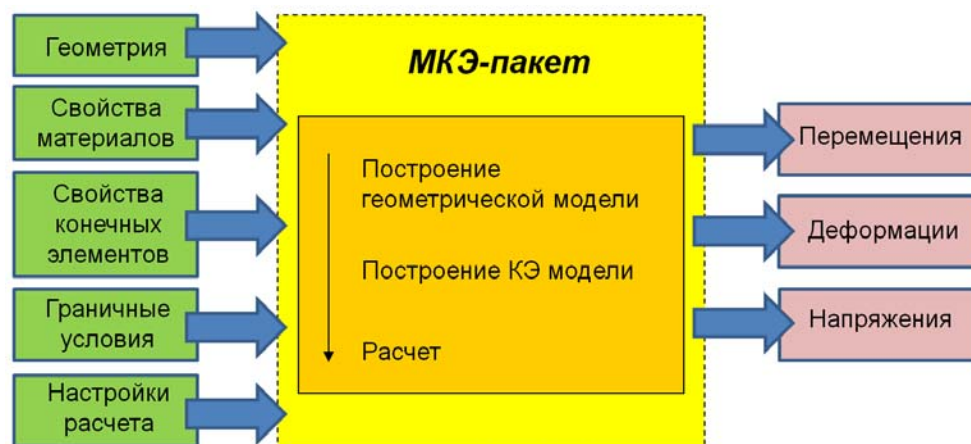
Рисунок 2 – Вариант реализации конечно-элементной модели конструкции для выполнения линейного статического расчета
