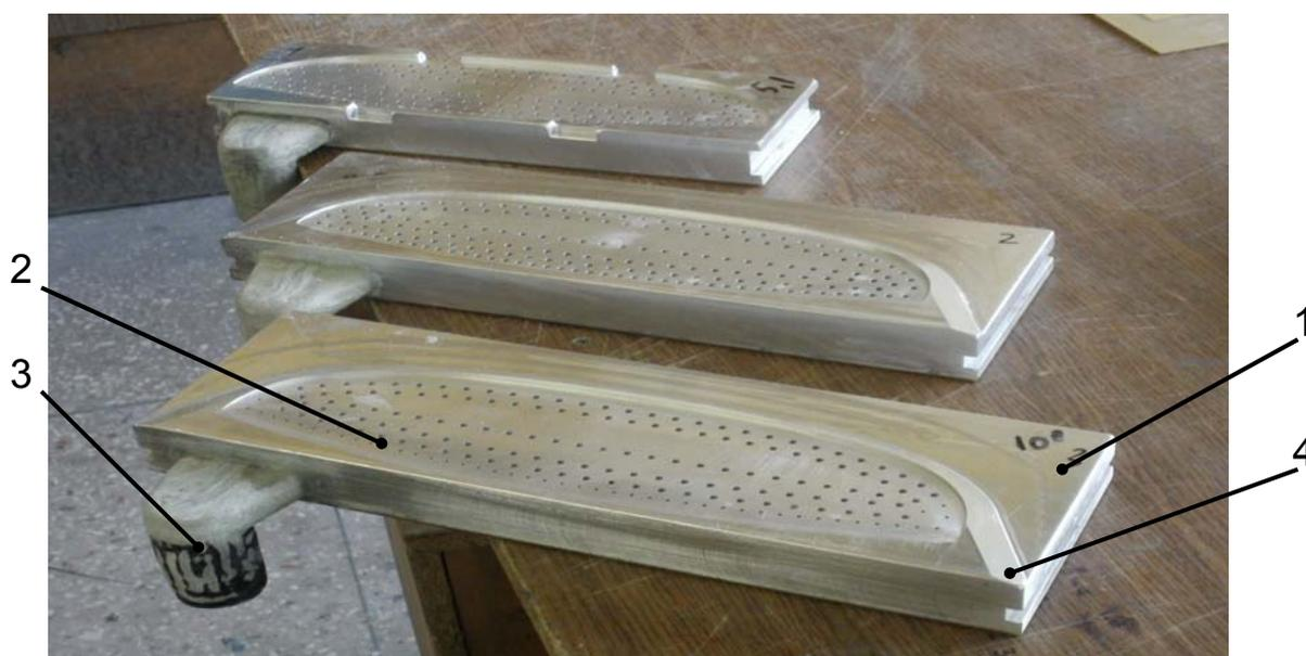
Рисунок 2 – Приспособление для обработки заготовки:
